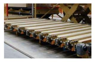
Intervalos de ajuste menores: As rodas dentadas e correntes continuam transmitindo movimento com eficiência, mesmo depois de elevado grau de desgaste, graças ao deslocamento
