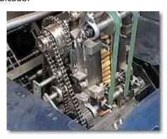
Resistem a temperaturas mais elevadas: Equipamentos principalmente da indústria siderúrgica, normalmente são acionados por correntes e rodas dentadas, já que estes elementos apresentam vantagens com relação aos sintéticos como as correias ou em relação aos sistemas de engrenagem que exigem lubrificação especial.
